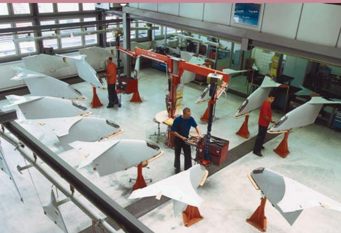
Finish-Arbeiten am Airbus A320 Wingtip bei der RUAG Aerospace in Emmen.
