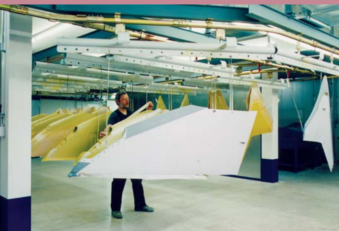
Ein Wingtip-Bauteil am Fördersystem in der Malerei.
